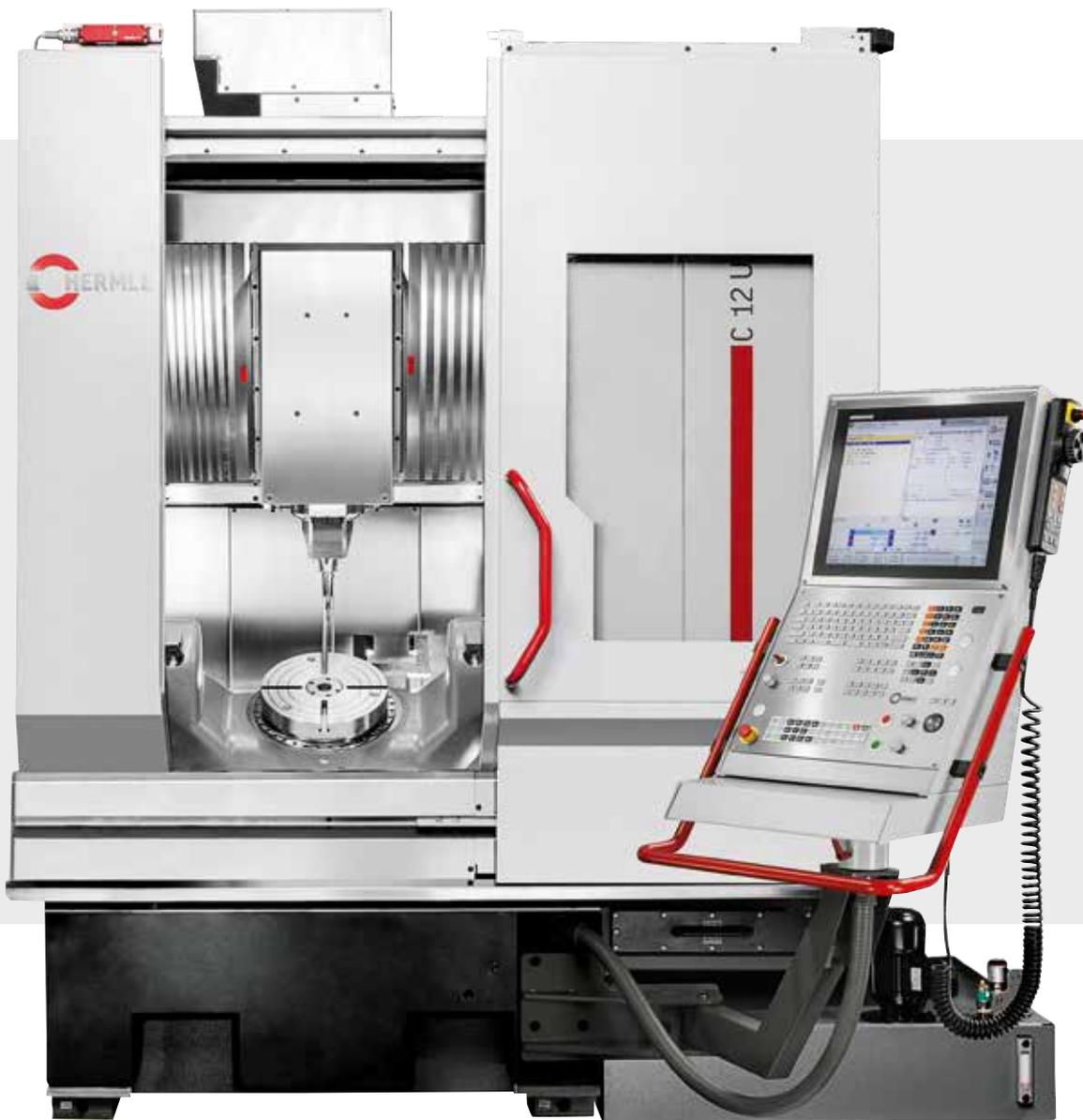
La compatta C 12 soddisfa l'esigenza dei clienti di una superficie di appoggio sempre più ridotta. Le corse di lavoro di 350 - 440 - 330 mm offrono i migliori presupposti per l'esecuzione di fresature su 5 lati / a 5 assi simultanei. Il magazzino utensili nella variante doppia può contenere 71 utensili.
