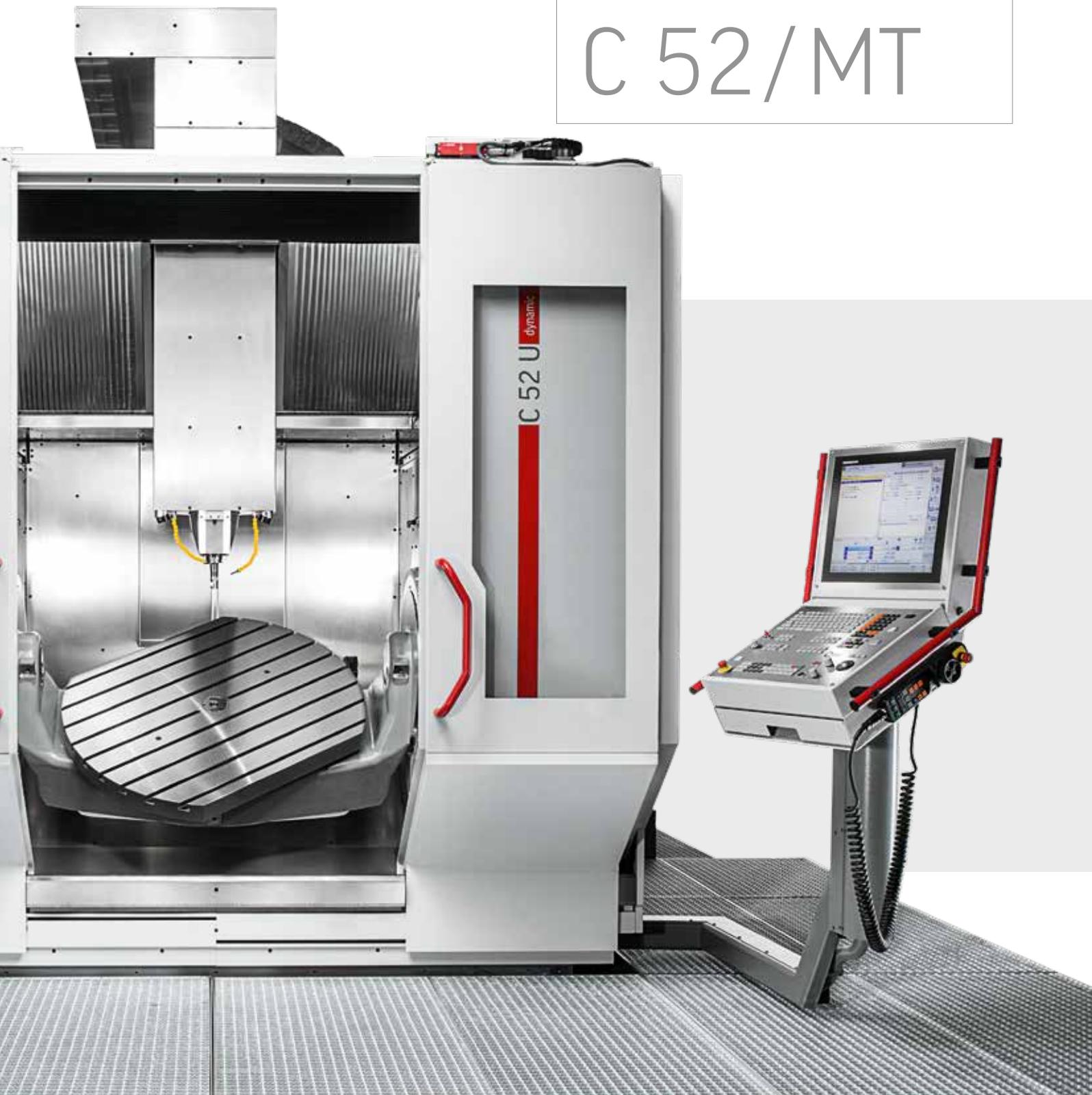
Con la C 52 U e la C 52 U MT e le loro varianti di tavola roto-basculante si possono lavorare a 5 assi simultanei pezzi fino a 2000 kg di peso mantenendo sempre e comunque la precisione richiesta; una grande sfida per la dinamica della macchina, che tuttavia non costituisce alcun problema per una Hermle. Disponibili anche come centro di fresatura/tornitura.
