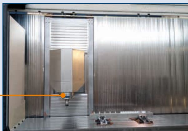
Testa speciale con elettromandrino HSK63 da 18000 giri.
