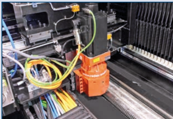
Doppio motore e cremagliera sull'asse X.
